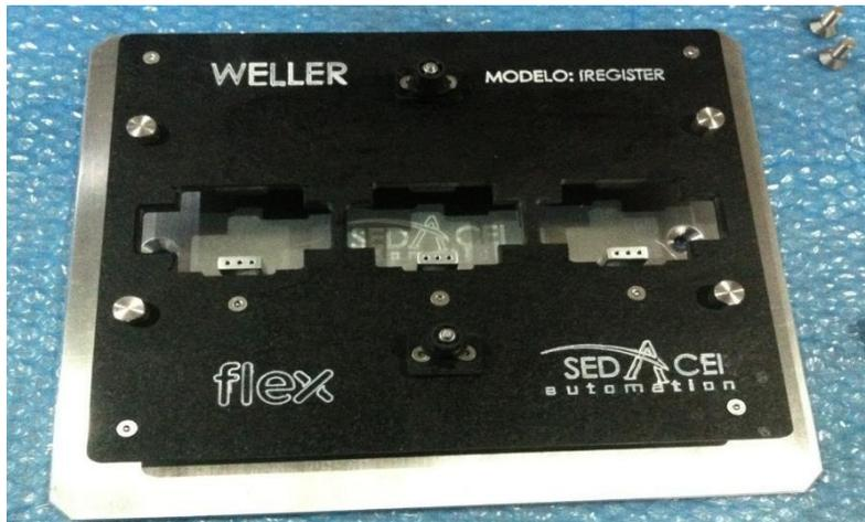
Figura 46. "Ensamble de Seguro y base para sujeción de pallet"
