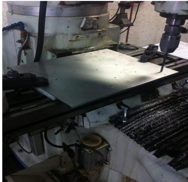
Figura 51. "Fabricación de barrenos en base para pallet"
