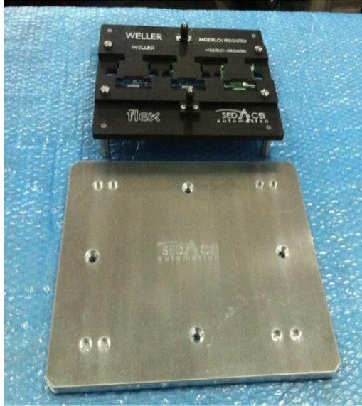
Figura 49. "Pallet y Base para mesa de robot"
